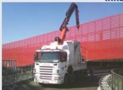
DVIŽNA ROKA do 30 m delovne višine + vakuumsko prijemalo
